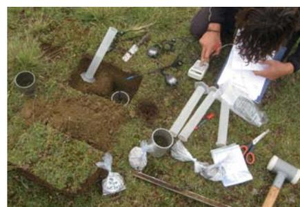
Verdunstung und Bodenwasserhaushalt werden im Freilandlabor auf Muntatsching im Halbstundtakt elektronisch erfasst (oben); diese Daten werden dann mittels GSM-Verbindung nach Bozen übermittelt und dort in Computermodelle eingespeist; manuelle Erhebungen (unten) dienen zum Abgleich dieser Modelle.
